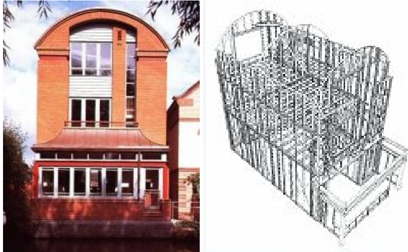
Figura 16 - Exemplo de uma residência com o emprego do sistema Light Steel Frame e seu esquema estrutural. O interessante desta casa é que mostra a versatilidade do sistema, que não preconiza uma forma arquitetônica. A criatividade pode ser explorada. Projeto: Adrian James Architects. Local: Oxford, EUA.
