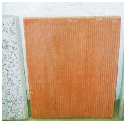
Fotografia 133 - Exemplo de painel de concreto, com acabamento frisado.
