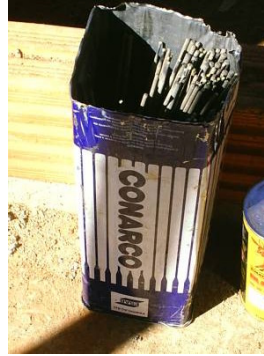
Fotografia 92 - Eletrodos utilizados para soldagem da estrutura de obra residencial.
