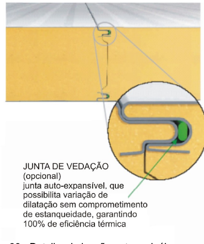
Figura 38 - Detalhe da junção entre painéis.
